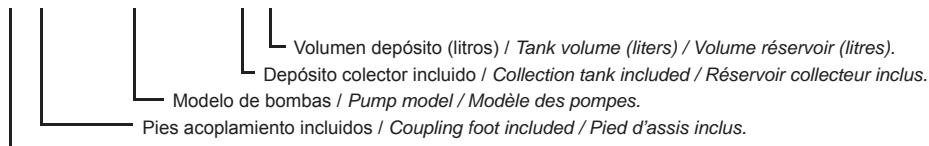
Tipo de estación de bombeo / Type of pumping station / Type de station de relevage.
