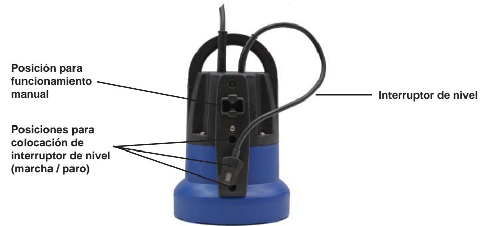
Figura 3 : Interruptor de nivel
